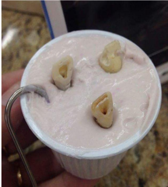
Figura 1 - Base experimental contendo algumas amostras fixadas em alginato.
